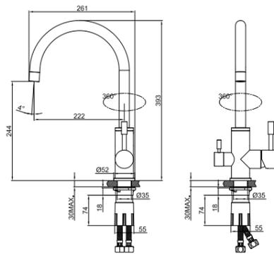
Смеситель для кухни из бессвинцовой латуни с каналом для фильтрованной воды **KF2osvli05**
