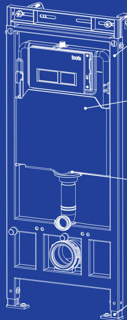
Рама изготовлена из стали толщиной 2,8 мм, что обеспечивает надежность всей конструкции. Специальное покрытие защищает металл от коррозии.
