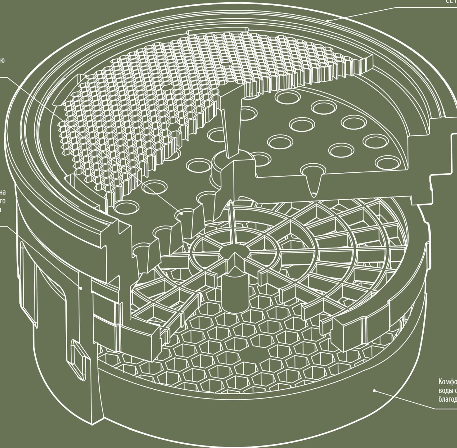
Комфортное направление струи воды одним движением пальца благодаря поворотному аэратору.
