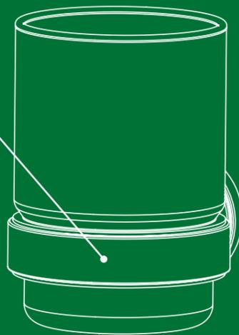
Специальная пластиковая прокладка между металлом и стеклянными и керамическими элементами обеспечивает их более плотную фиксацию и предотвращает повреждение изделий.
