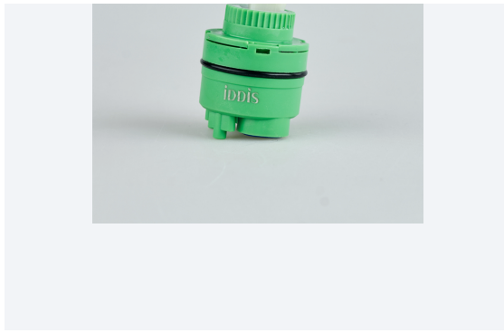
Картридж керамический для смесителя, 35 мм, без ножек, с верхним уплотнителем, IDDIS, 999C35D1SM
